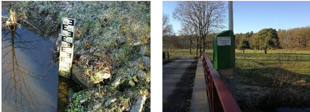
Abbildung 9: Pegel Averhoy an der Auter; links: Kontrollpegellatte; rechts: Datenlogger mit Datenfernübertragung
